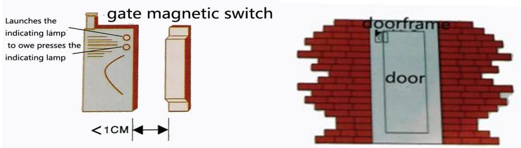
(Рисунок слева: дверной магнитный датчик. Расстояние между магнитом и ответной частью <1 см., запуск индикаторной лампы, индикаторная лампа. На рисунке справа показано размещение датчика на двери).
