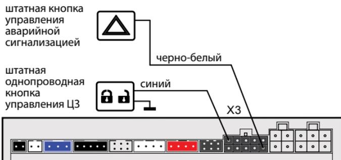
Выходы альтернативного управления активируются автоматически (после установки в блок 2CAN или CAN+LIN модуля и записи в память комплекса номера, соответствующего Вашему автомобилю). Активный управляющий уровень - отрицательный. Информацию о возможности альтернативного управления и способах подключения Вы можете найти на странице [can.starline.ru](http://can.starline.ru)
