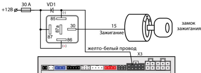
**Схема реализации режима охраны с работающим двигателем и режима турботаймера (для автомобилей с кнопкой «старт-стоп»)**
