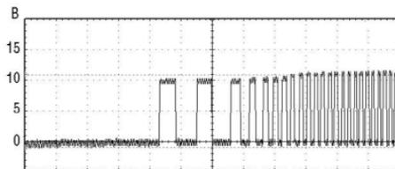
Момент прекращения прокручивания стартера комплекс определяет по резкому возрастанию частоты сигнала в момент начала работы двигателя. Подключение серо-черного провода к такой цепи гарантирует правильное отключение стартера. Заведенному двигателю соответствует частота - около 20 Гц или 600 об/мин.
