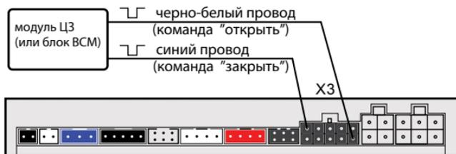
Для классического слаботочного управления ЦЗ необходимо будет использовать доп. каналы №4 (закрыть) и №5 (открыть), контакты 10 и 1 разъема X3. При этом функции 12 и 19 таб. №1 следует запрограммировать на вариант 3. Длительность импульсов управления программируется функцией 1 таб. №1 (см. стр. 75).
