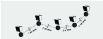
Система «Автодория» позволяет осуществлять непрерывный контроль за характером движения ТС, задействуя регистратор в нескольких зонах контроля одновременно. Например, три прибора могут образовать две зоны непрерывного контроля, четыре - три зоны контроля и т.д.
